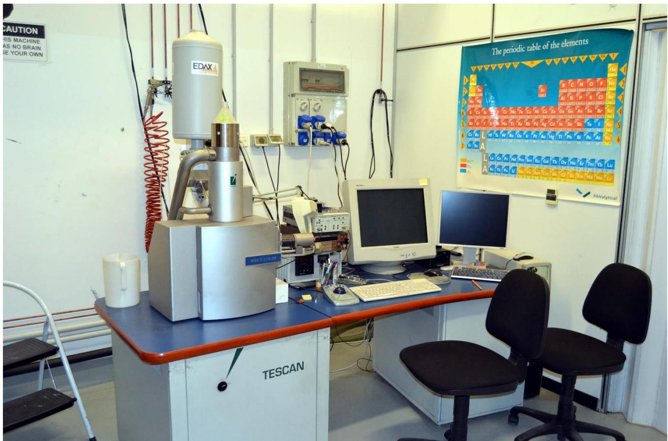
**Abbildung 1:** Rasterelektronenmikroskop Vega TS Tescan Univac 5163 XM mit energiedispersiven System (EDS) EDAX Genesis 4000 XMS Imaging 60 SEM, am Institut für Umwelt- und Geowissenschaften der Universität von Mailand-Bicocca.
